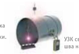
6 Сварка наружного поперечного шва,
