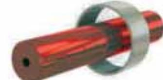
11 Нанесение стеклосмазки, прессование на прессе 2000 т, обрезка пресс-остатков.
