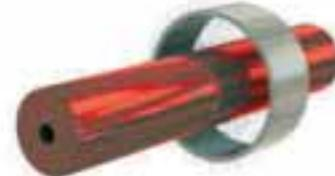
7 Нанесение стеклосмазки.
